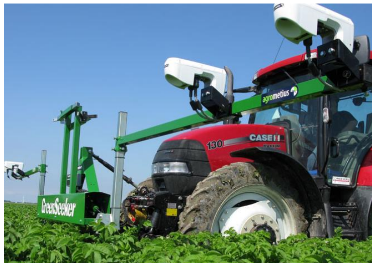
Slika 1.11. GreenSeeker sistem – postavljen na prednji podizni mehanizam traktora ( https://agriculture.trimble.com )
